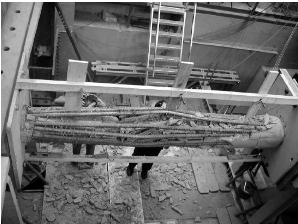
Abbildung 9: Bruchbild der Stütze C1 mit einer Querbewehrung von \varnothing 6 / 20 cm.
