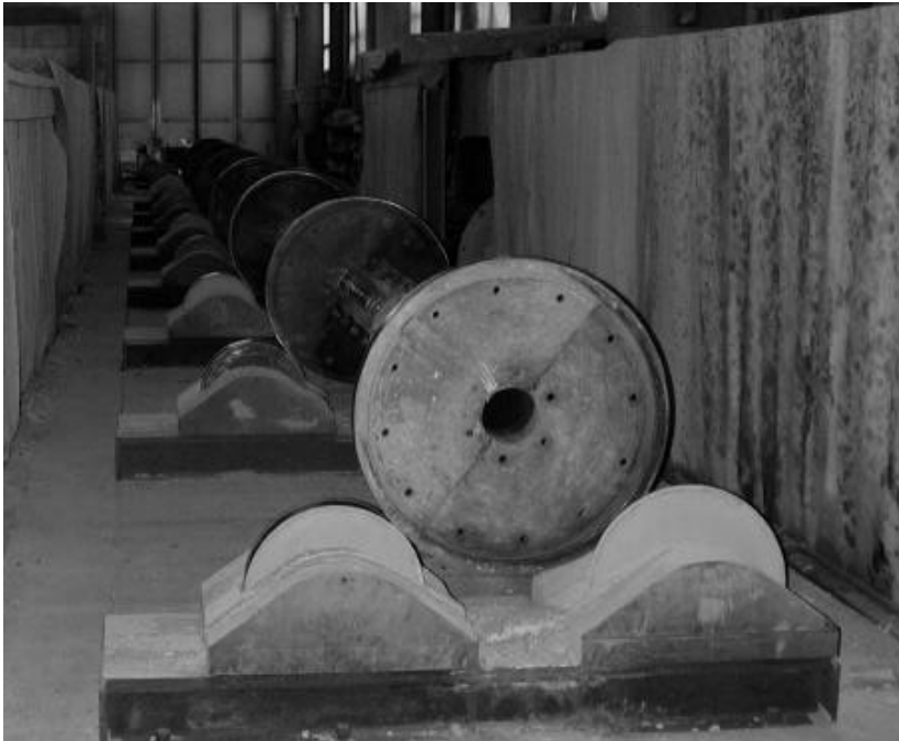
Abbildung 1: Schalung für Schleuderbetonstützen auf der Rollenbank.
